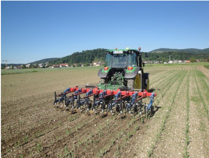
Slika 1: Prvi prehod s prstastim okopalnikom v strategiji 4 (MEH) z izključno mehanskimi ukrepi zatiranja plevela konec maja 2020
